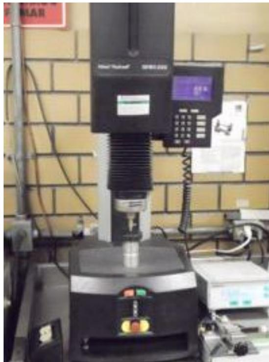
Fig. 16 Equipo medidor de dureza Rockwell F.
