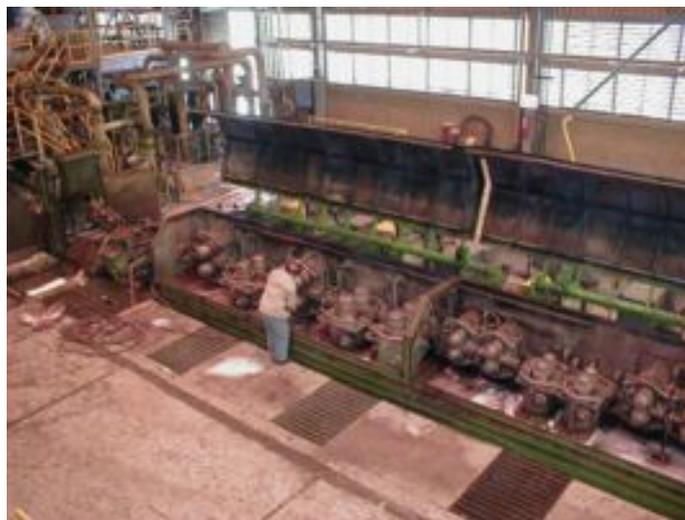
Fig. 10 Laminadora con sus 12 castillos de laminación.
