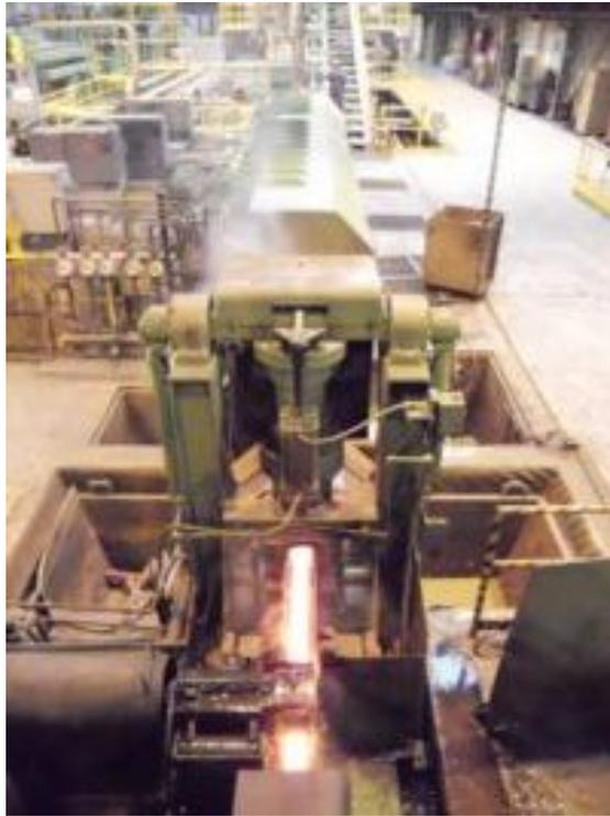
Fig. 8 Pinch Roll # 1 y cortadora de péndulo.
