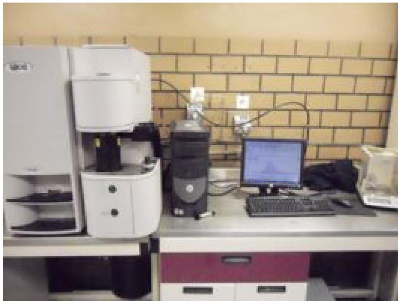
Fig. 15. Equipo analizador de oxígeno Leco.
