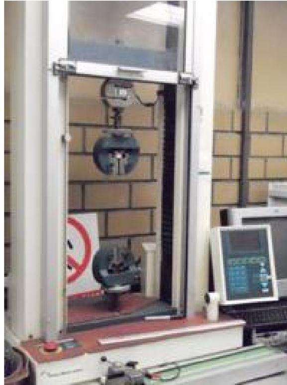
Fig. 17. Máquina de tensión.
