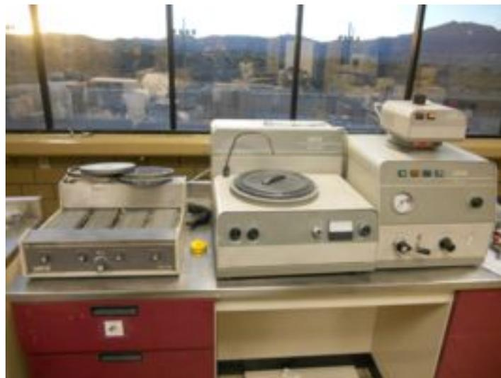
Fig. 14 De izq. a derecha. Equipo para lijar Leco DS-20, pulidora VP-60 y montadora Leco PR-32.
