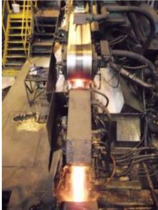
Fig. 7 Salida del Caster y Enfriamiento Secundario.
