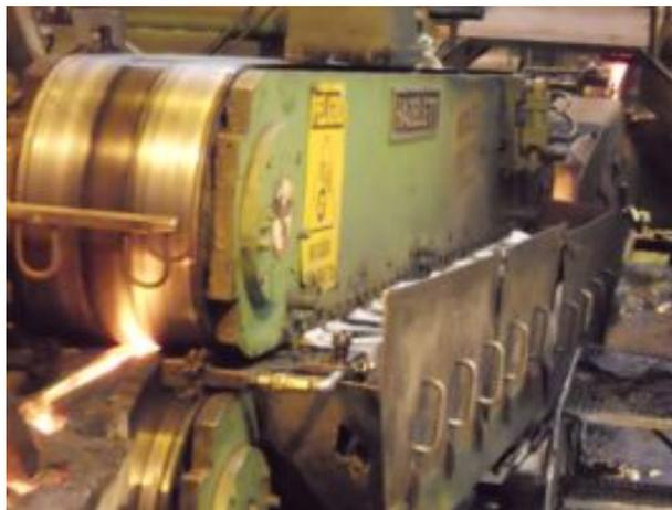
Fig.6. Máquina de moldeo (Caster) de colada continua.
