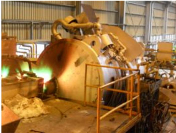
Fig. 4 Horno de Retención.
