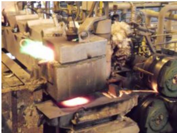
Fig. 5 Canal # 2 con el tundish y entrada al caster.
