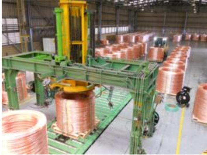
Fig. 12 Compactadora de rollos.
