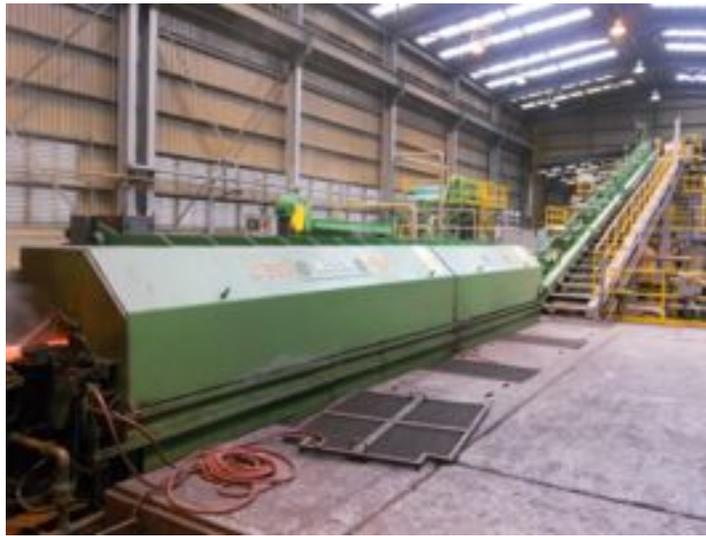
Fig. 11. Tren de Laminación y línea de decapado.
