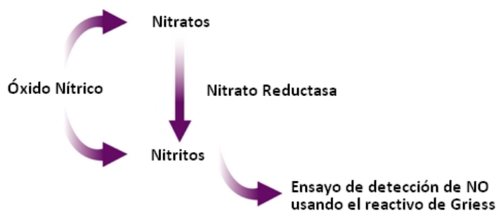
Figura 11. Mecanismo de detección de nitratos y nitritos (metabolitos estables de la síntesis de óxido nítrico) empleando el reactivo de Griess.
