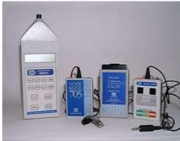
Fig. 3.1 Equipos de Medición sonómetro
