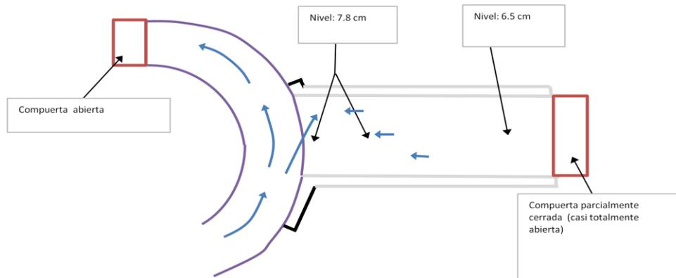
Fig 4.1 Esquema del modelo hidráulico con ambas compuertas abiertas.
