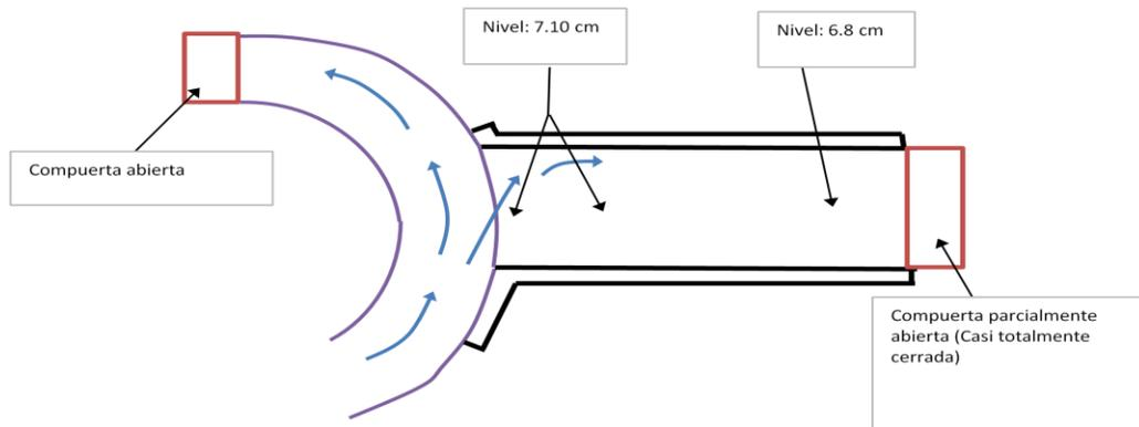
Fig 4.4 Esquema del modelo hidráulico con la compuerta del vertedor casi cerrada.
