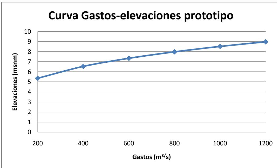
Fig 7.2 Gráfica gastos-elevaciones prototipo.
