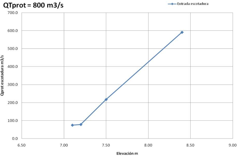
Fig 4.9 Gráfica elevaciones-gasto para un gasto sobre el río la Sierra de 800 m<sup>3</sup>/s
