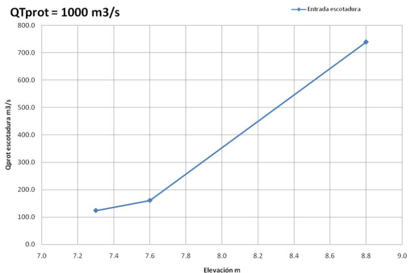
Fig 4.8 Gráfica elevaciones-gasto para un gasto sobre el río la Sierra de 1000 m<sup>3</sup>/s
