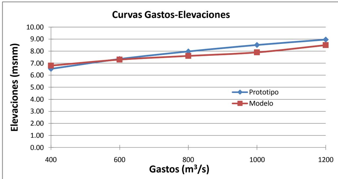
Fig 6.5 Gráfica gasto vertedor-elevaciones, modelo y prototipo.
