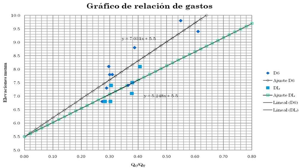
Fig 4.15 Gráfica de ajustes de los porcentajes de vertido-elevaciones.
