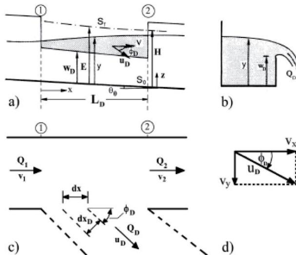
Fig. 3.1 Esquema de los parámetros geométricos e hidráulicos del canal principal y del vertedor lateral: a) sección longitudinal, b) sección transversal, c) vista de planta y d) definición del ángulo de salida lateral
