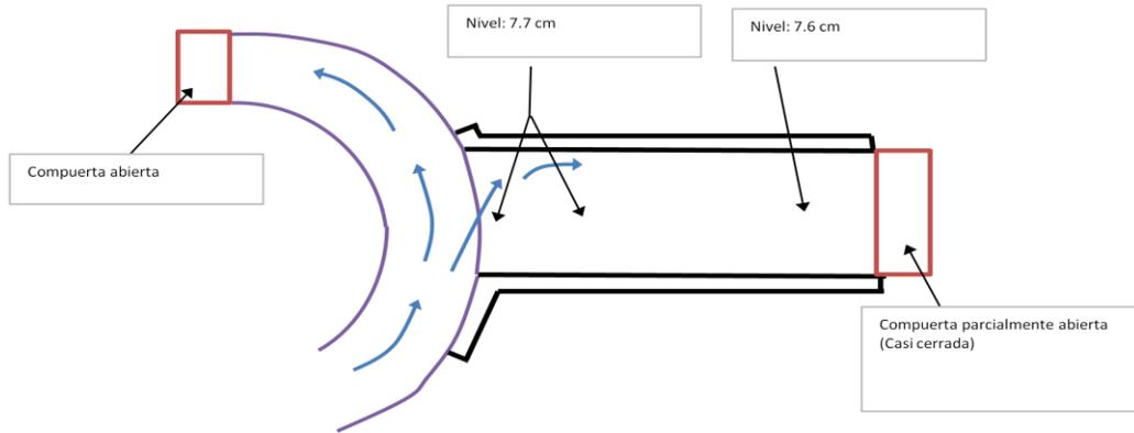
Fig 4.3 Esquema del modelo hidráulico con la compuerta del vertedor casi cerrada
