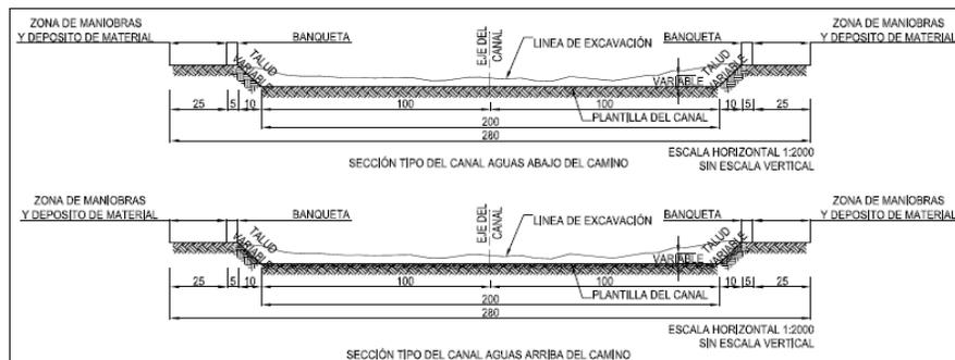
Fig 1.3 Sección transversal del canal
