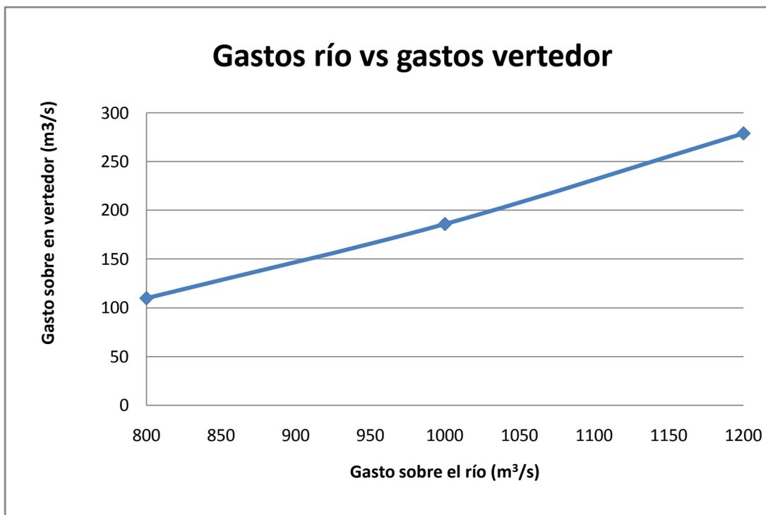
Fig 4.5 Gastos del río vs gastos sobre el vertedor medidos.
