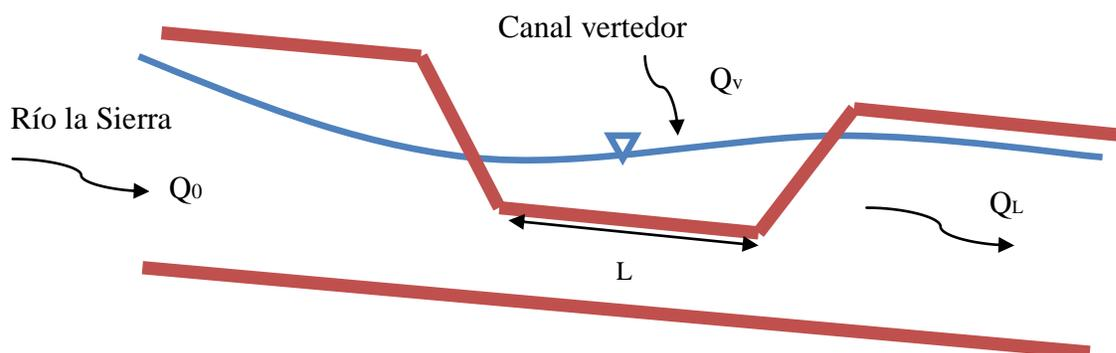
Fig 9.1 Perfil hidráulico del río en su tramo del vertedor.
