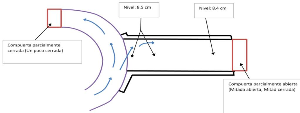
Fig 4.2 Esquema del modelo hidráulico con la compuerta del vertedor parcialmente cerrada.
