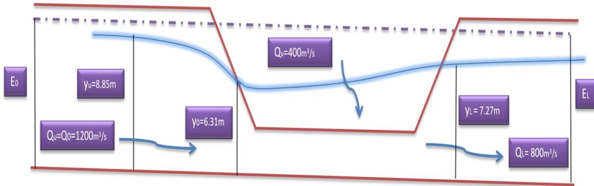
Fig 9.3 Perfil hidráulico para las condiciones de diseño.
