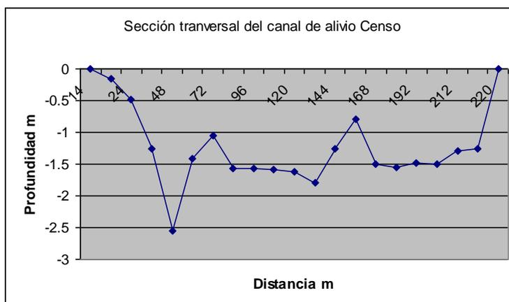
Fig 5.6 Sección transversal del canal vertedor.
