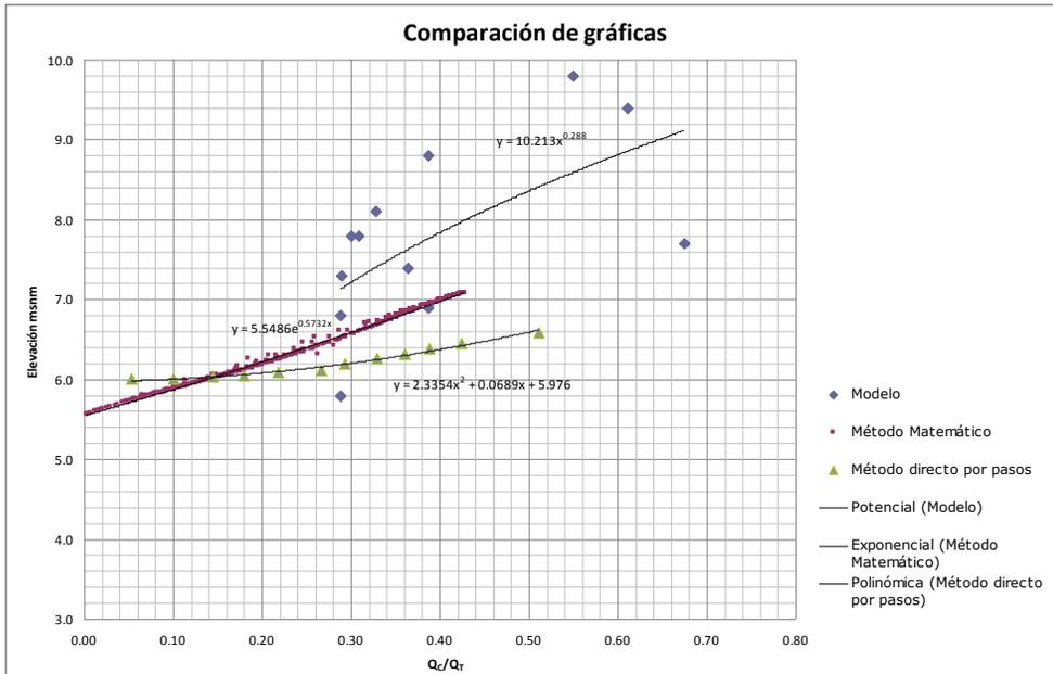
Fig 4.17 Gráficas gastos canal vertedor-elevaciones.
