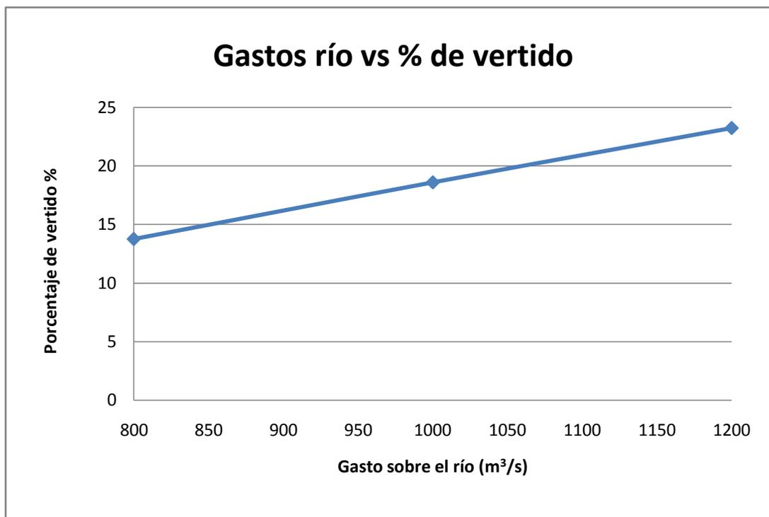
Fig 4.6 Gastos del río vs % de vertido medidos.
