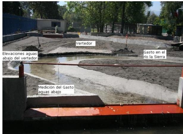
Fig 6.1 Modelo Hidráulico Censo.
