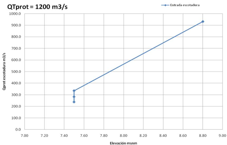
Fig 4.7 Gráfica elevaciones-gasto para un gasto sobre el río la Sierra de 1200 m<sup>3</sup>/s
