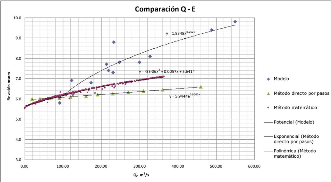
Fig 4.16 Gráficas gastos canal vertedor-elevaciones.
