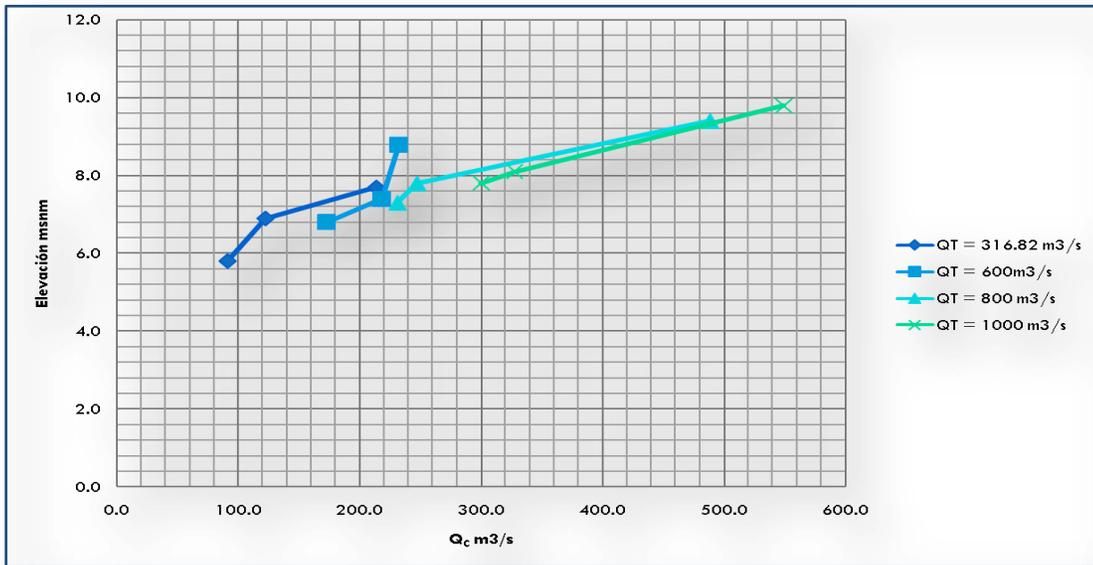
Fig 4.11 Gastos sobre el canal para diferentes gastos y condiciones de la compuerta del modelo del río la Sierra.
