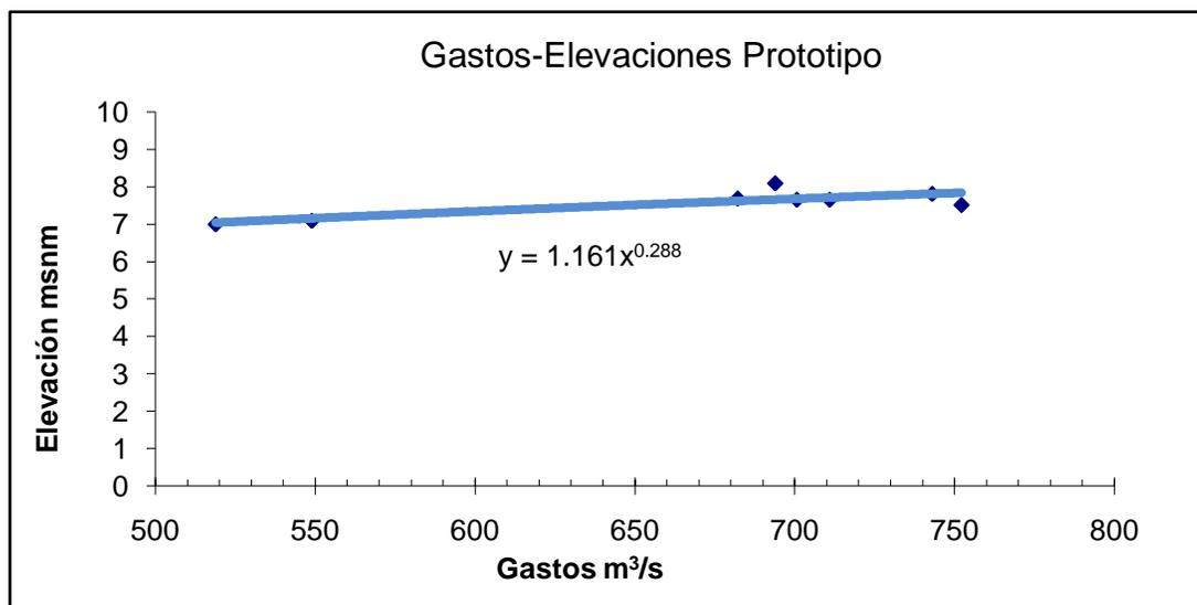
Fig 7.1 Gráfica gastos-elevaciones prototipo.
