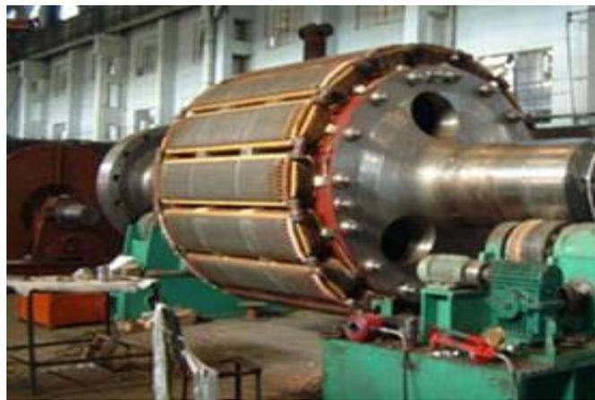
**Figura 2.3 Rotor de un motor síncrono.**
