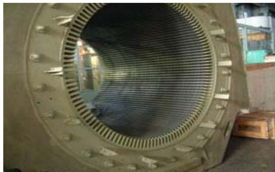
***Figura 2.1 Estator de un motor síncrono.***
