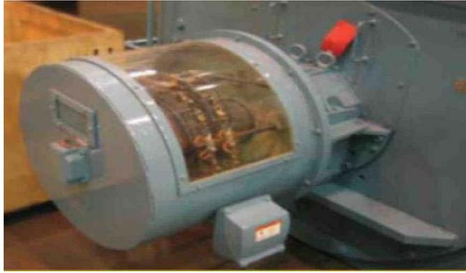
**Figura 2.2 Anillos colectores de excitación al rotor.**
