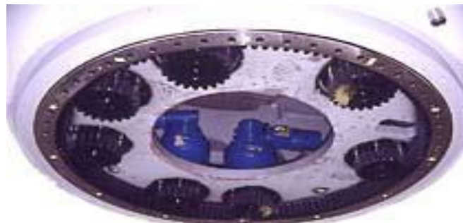
Ilustración 31. Mecanismo de orientación de una máquina típica de 750 kW.
