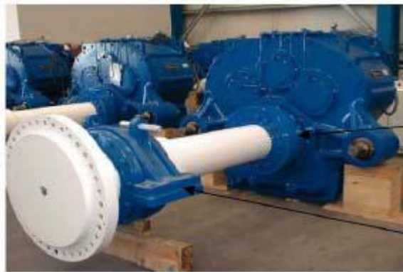
Ilustración 19. Eje de baja velocidad de una aeroturbina © 1998 www.windpower.org
