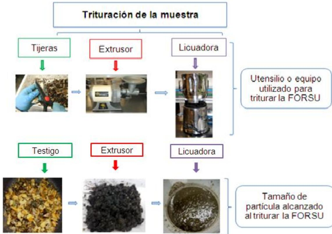
**Figura 4.3.** Trituración de la muestra.
