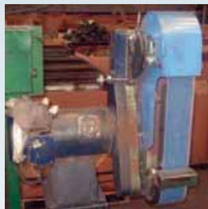
2.- Lija: este proceso está compuesto por veintidós maquinas lijadoras de banda de diferente grosor, divididas en seis maquinas de 2", doce de 4" y cuatro de 8" pulgadas. El uso de los diferentes grosores depende del tamaño de las piezas que requieran dicho proceso.
