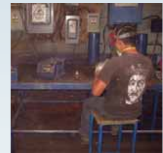
8.- Mototool: es el proceso en el que se limpian las piezas y se liberan de imperfecciones utilizando un esmeril de mano.
