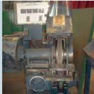
1.- Piedra: consiste en el esmerilado de las piezas recibidas en mal estado y que requieren de la reducción o acabado específico que no haya podido lograrse en la fundición.
