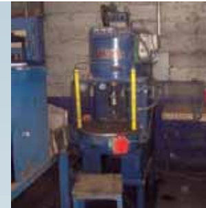
5.- Prensa: este proceso se encarga de corregir y rectificar la forma de las piezas de fundición por medio de una prensa hidráulica que ejerce una fuerte presión sobre el material. Actualmente, sólo se cuenta con dos máquinas que ejercen una presión de 30 y 40 toneladas respectivamente.
