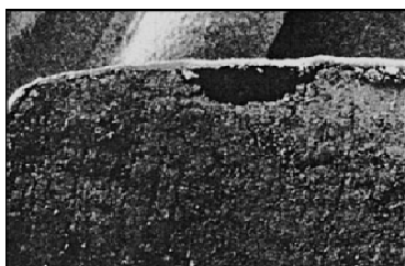
Figura 12 Puenteado [McGinity et al, 1996].
