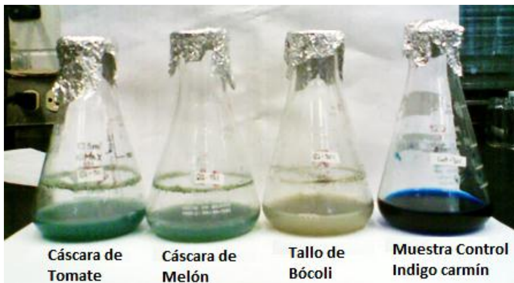
Figura 14. Muestras con extracto diluido de la cáscara de tomate verde, cáscara de melón y tallo de brócoli después de 48 h de biodegradación comparadas con la muestra control de índigo carmín.
