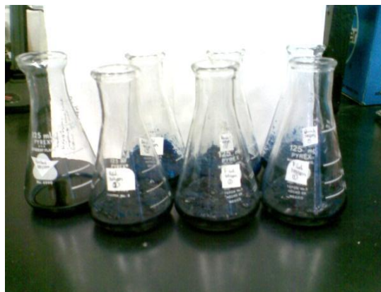
Figura 10. Muestras preparadas para la biodegradación del bagazo de los vegetales tallo de flor de calabaza y tallo de brócoli junto a la muestra control.
