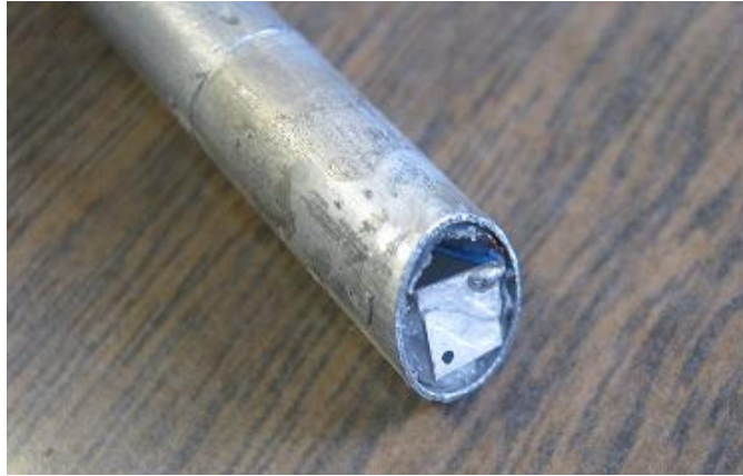
Figura 3.6. Cerámica fracturada después de despegar el “matching” (Rexolite) del transductor.
