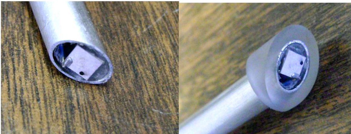
Figura 2.25. Carcasa completa con la cerámica (izquierda), y carcasa completa con la cerámica y el soporte (derecha).
