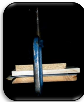
Figura 30. Placa de silicón presado entre dos planchas de madera y el suaje.
