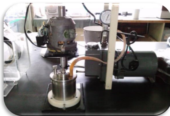
Figura 19. Recipiente de acero inoxidable conectado a una bomba de vacío.
