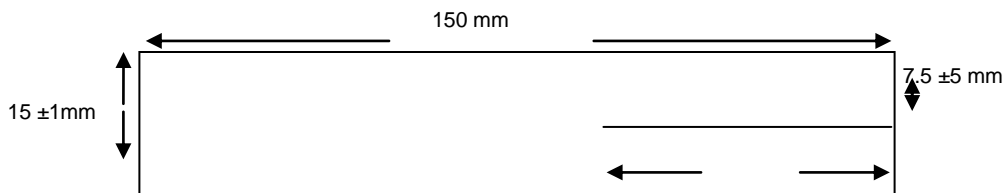
Figura 11. Diseño de suaje para desgarre. Dimensiones recomendadas para la realización de la probeta para la prueba de desgarre.
