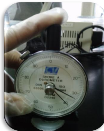
Figura 27. Medición de la dureza sobre una muestra elastómerica, en cinco zonas de dicha muestra.
