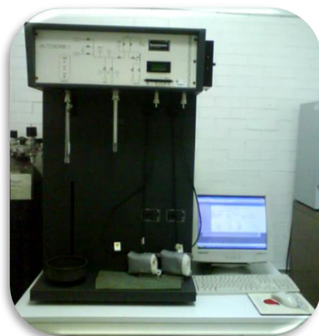
Figura 22. Equipo AUTOSORB 1 equipado con baño de nitrógeno líquido.
