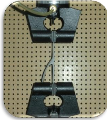
Figura 32. Posición de la muestra en la máquina universal de pruebas mecánicas INSTRON®.
