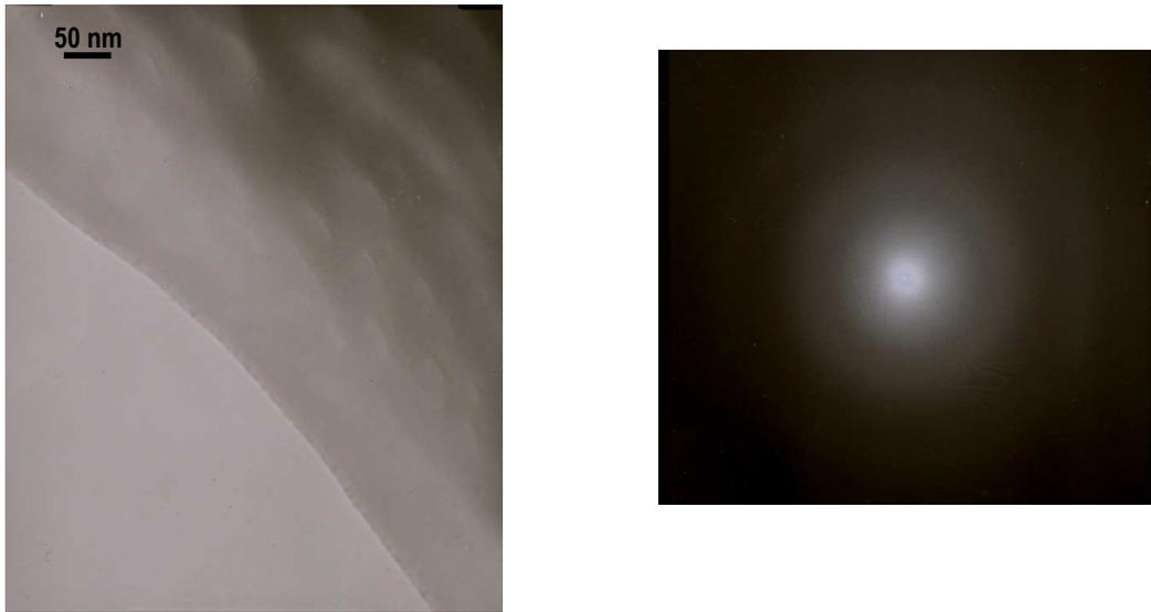
Figura 49. Micrografía TEM de la aleación amorfa  $\text{Fe}_{80}\text{B}_{10}\text{Si}_{10}$  a) Campo claro b) Patrón de difracción.
