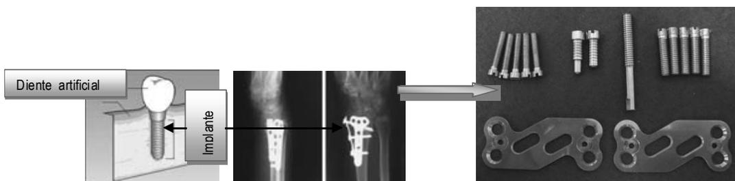
Figura 4. Aleación amorfa  $Ti_{40}Zr_{10}Cu_{36}Pd_{14}$  como aplicación en implantes dentales y placas de fijación [5]
