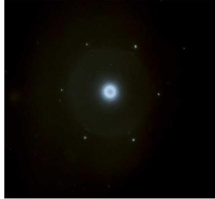
Figura 70. Micrografía TEM para la aleación amorfa  $x=0$  con 5 minutos de tratamiento térmico a  $500\text{ }^{\circ}\text{C}$  a) campo oscuro, b) Patrón de difracción. Se observan nanocristales que en general presentan tamaños del orden de  $10\text{ nm}$ .
