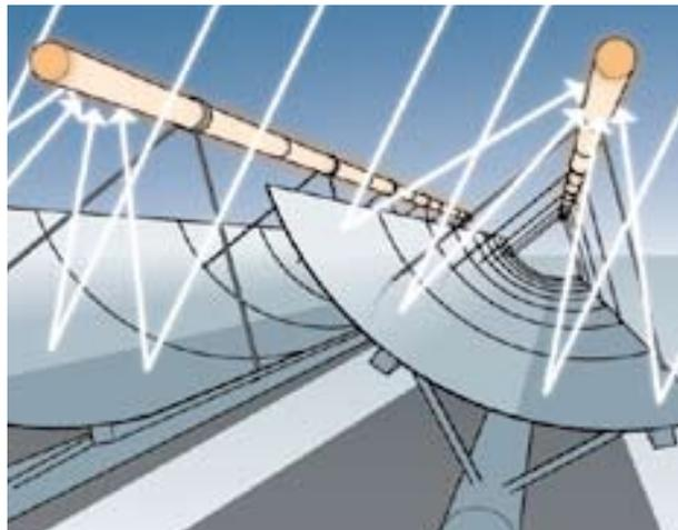
Esta figura corresponde a un concentrador de canal parabólico. Se puede apreciar que los rayos del sol (representados por las líneas blancas) son reflejados por unas placas parabólicas hacia un tubo de sección reducida; a través del tubo circula el fluido de trabajo que transporta la energía en forma de calor.
