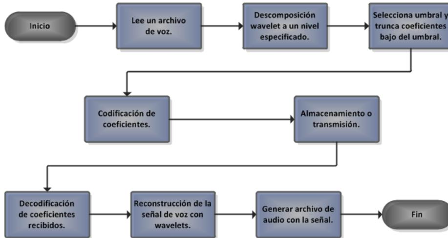
Figura 3.14: Diagrama de compresión y reconstrucción de voz.
