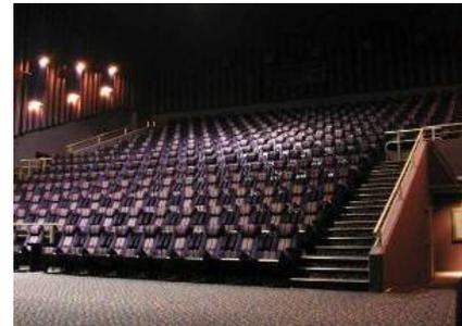
**IM.40** – Los muros deben ser diseñados evitando paralelismos entre sus superficies
