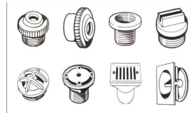
Fig. Accesorios, Boquillas de retorno y aspiradora
