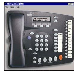
Fig. 93 Teléfono de Software
