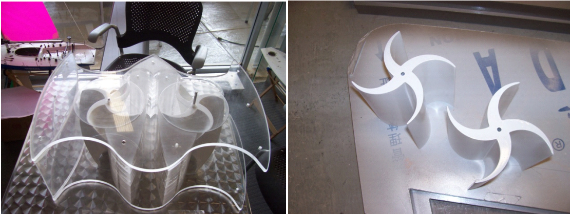
Figura 5-10 Dispositivo terminado, concentradores circulares, rotores rectos y helicoidales.
