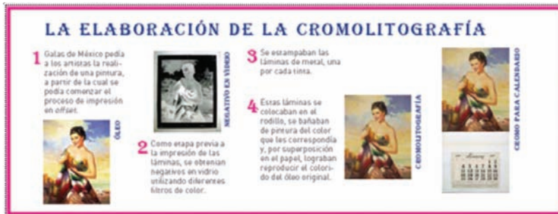
Fig. 50 Esquema para ejemplificar la elaboración de la cromolitografía en los calendarios de Galas de México.
