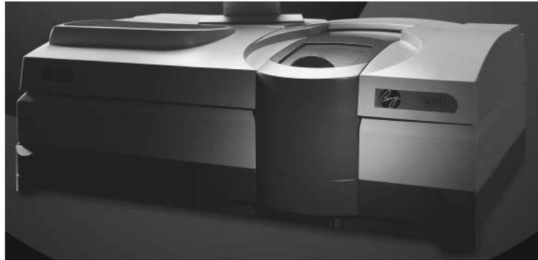
Figura 4.1: Aspecto del espectrofotómetro Cary 5000, con el cual se obtuvieron los espectros de absorción.
