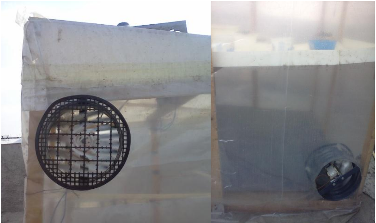
5. Ubicación de los ventiladores como sistema de enfriamiento en clima cálido.
