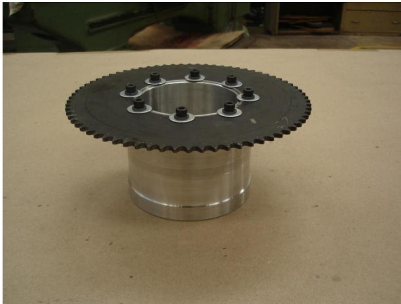
Figura 3.3 Catarina de 72 dientes sujeta al eje, con detalle del tope en el eje
