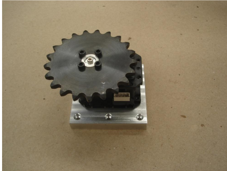
Figura 3.7 Catarina de 21 dientes sujeta al motor montado en su soporte
