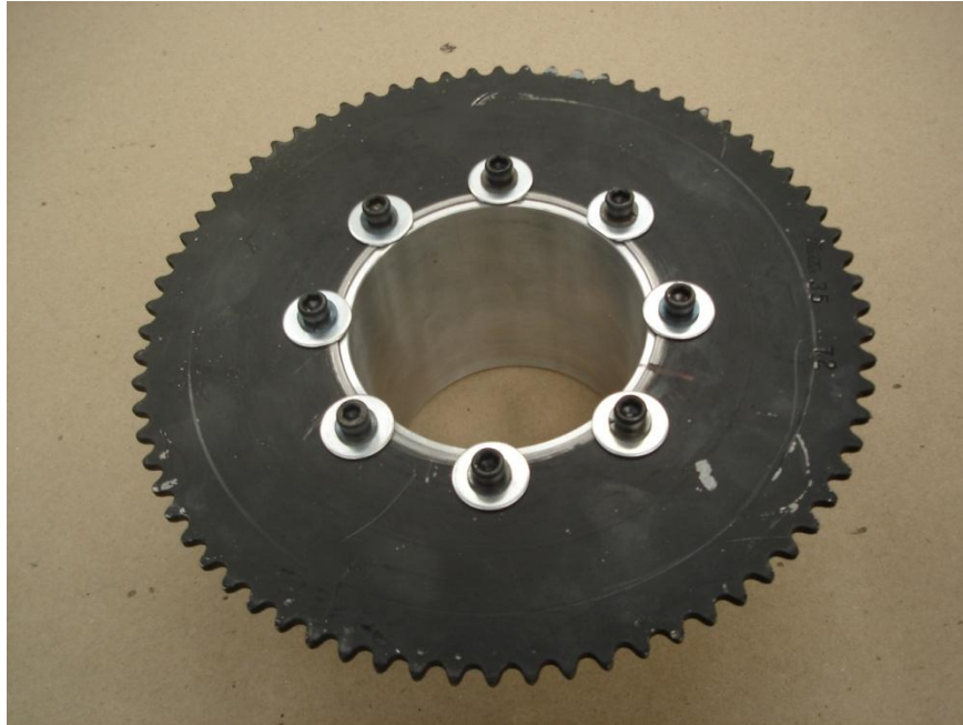
Figura 3.6 Catarina de 72 dientes sujeta al eje
