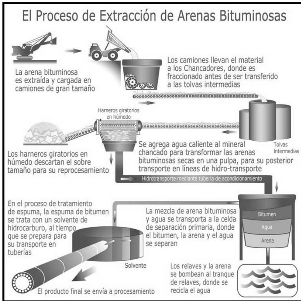
Figura 3.70 Esquema que indica el proceso de extracción de Arenas Bituminosas (Tomado de Shell, 2008).
