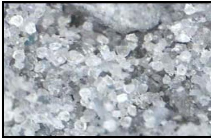
Figura 3.35 Imagen de litarenitas del pozo Lankahuasa -1, 2655 m (Tomado de PEMEX, 2002).
