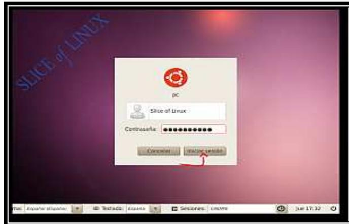
Figura A25 GDM, gestor de acceso para el X Window System
