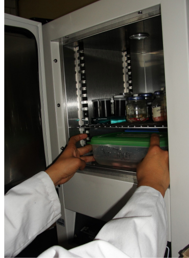
Figura 16.1 y 16.2- Amalgamas pulidas y no pulidas inmersas en un recipiente de plástico con agua. Las muestras se metieron en el horno de temperatura controlada.
