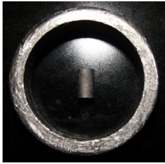
Figura 12.- Colocación del espécimen y anillo metálico sobre la loseta de vidrio.
