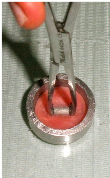
Figura 13.- Especimen no cubierto en su totalidad por acrílico.
