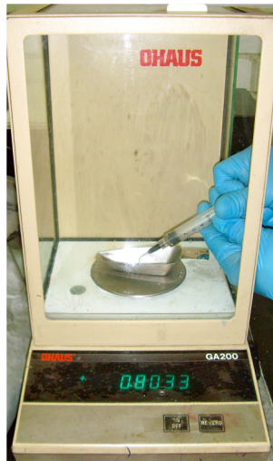
Figura 6.- Eliminación del exceso de mercurio.
