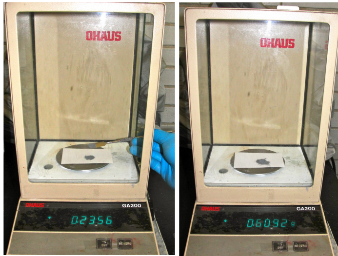
Figura 4.1 y 4.2- Colocación de la aleación en polvo en la balanza analítica, y su peso final.
