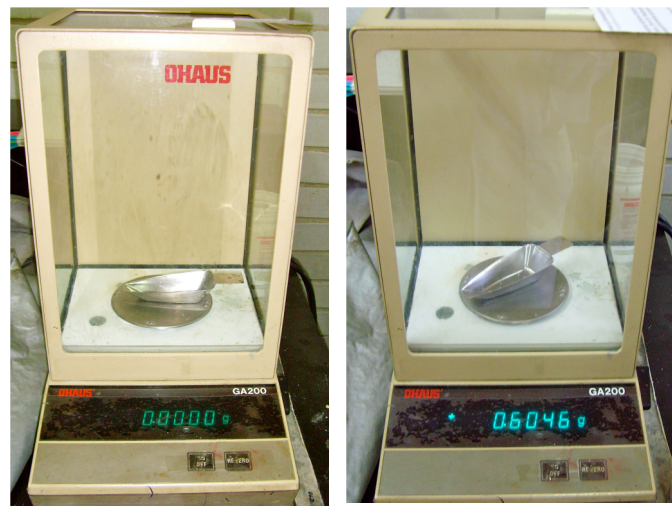
Figura 5.1 y 5.2 – Calibración a cero del contenedor de la muestra de Hg. Peso del Hg sugerido por el fabricante.
