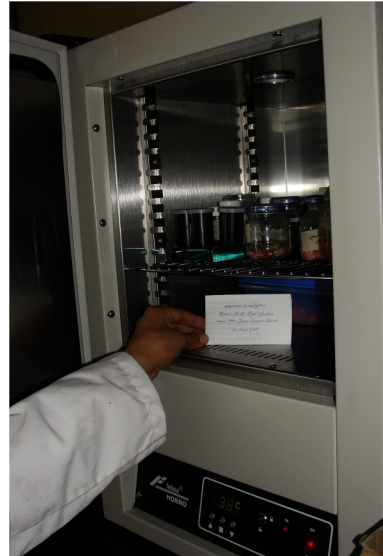
Figura 11.1 y 11.2 – Obtención de especímenes y colocación de estos en la estufa de temperatura controlada.
