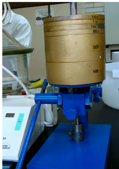
Figura 10.1 y 10.2 - Molde para la elaboración del espécimen sometido a una carga de 17.940 kg. Remoción del exceso de Hg.
