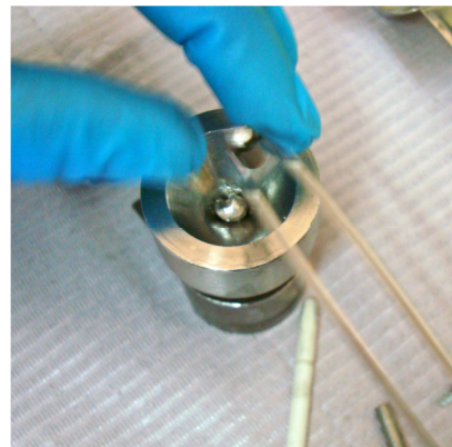
Figura 9.1 – 9.2 – Molde sugerido por la norma #1 de la ADA. Colocación de la amalgama en el molde para la elaboración de especímenes.
