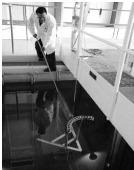
Figura 65. Maniobras para colocar una muestra en el SIFCA: se toma el “*rabbit*” con una pinza especial, se introduce el SIFCA a la piscina y se sumerge hasta el fondo de la piscina (Ortega Escalona, 2008: 30).
