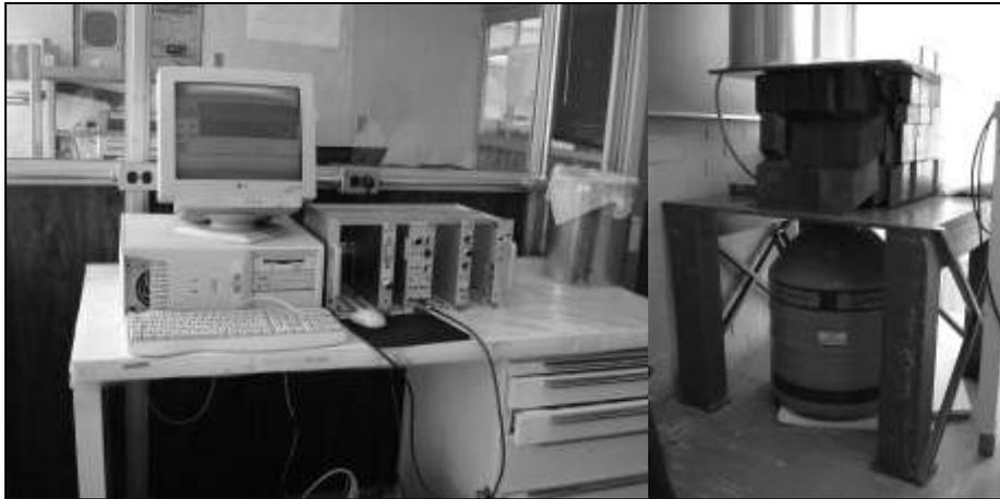
Figura 66. Detector acoplado a una computadora que funciona como un analizador multicanal.
