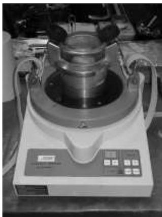
Figura 60. Pulverizador automático de ágata.
