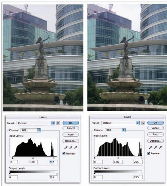
**Figura 3-4-15.** Corrección por puntos finales en una imagen.
