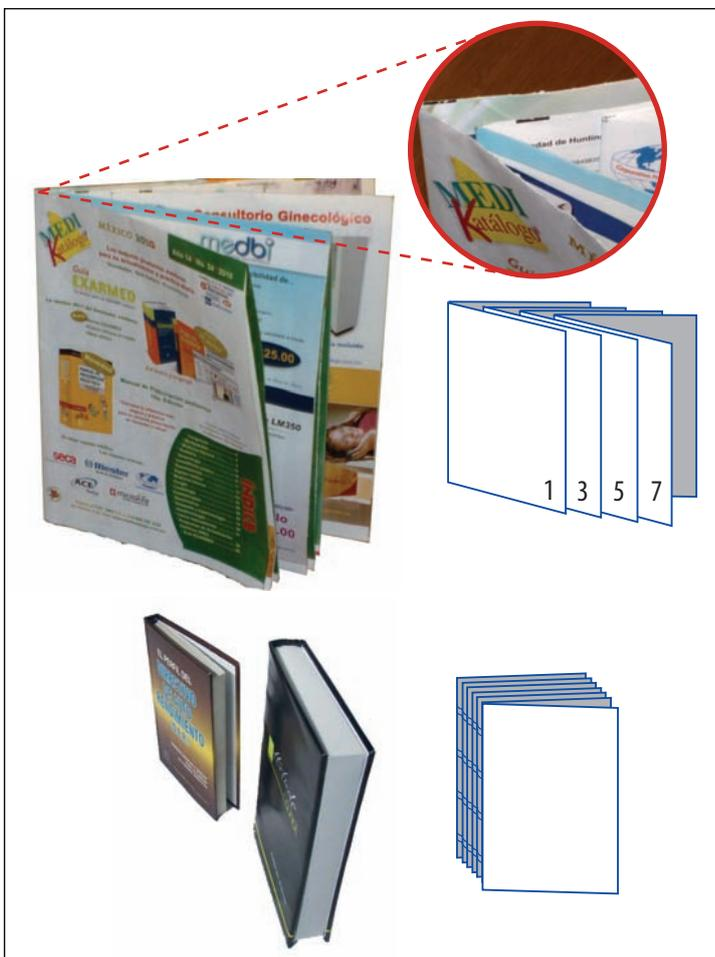
**Figura 4-8-6.** El alzado de pliegos consiste en ir colocando sucesivamente un pliego, previamente plegado a modo de cuadernillo dentro de otro similar o continuo. Existen máquinas que realizan este trabajo en línea con una cosedora.
