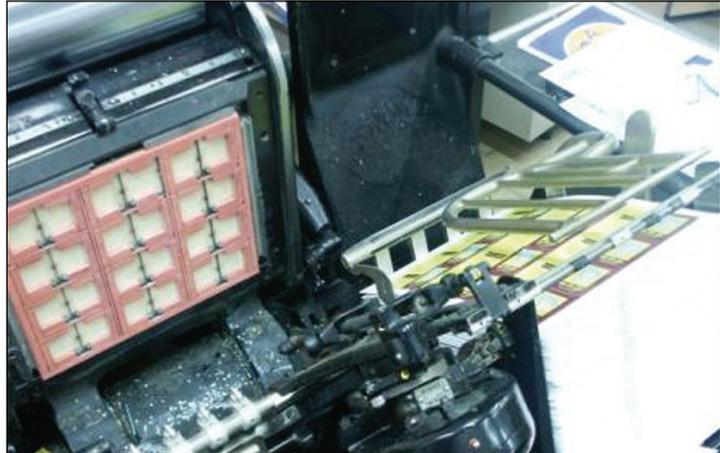
**Figura 4-8-14.** El troquel plano es de perfil liso y la base contra la que actúa es metálica. Su movimiento es perpendicular a la plancha.
