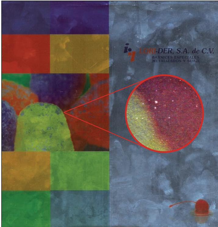
**Figura 4-2-10.** Ejemplo impreso con tramado estocástico.
