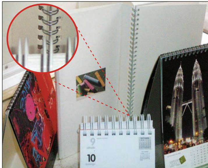
**Figura 4-8-32.** El gusano de alambre se pasa por los agujeros de las páginas y se cierra para sujetar a las mismas, se utiliza comúnmente en calendarios y publicaciones corporativas; su durabilidad y resistencia lo colocan en la preferencia en lugar del gusano de plástico.
