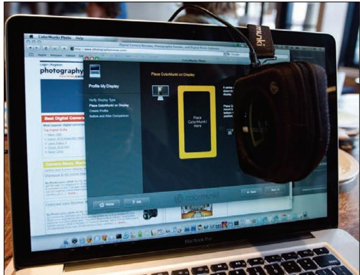
Figura 3-3-3. Dispositivo de calibración.
