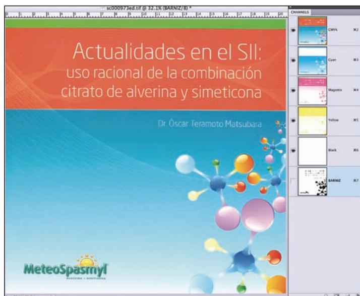
**Figura 4-7-14.** En cualquier impreso que se desee aplicar barniz a registro el impresor siempre lo considerará como impresión de una tinta adicional, tanto en pre prensa e impresión; de igual manera se tendrá que hacer lo mismo en los archivos digitales.
