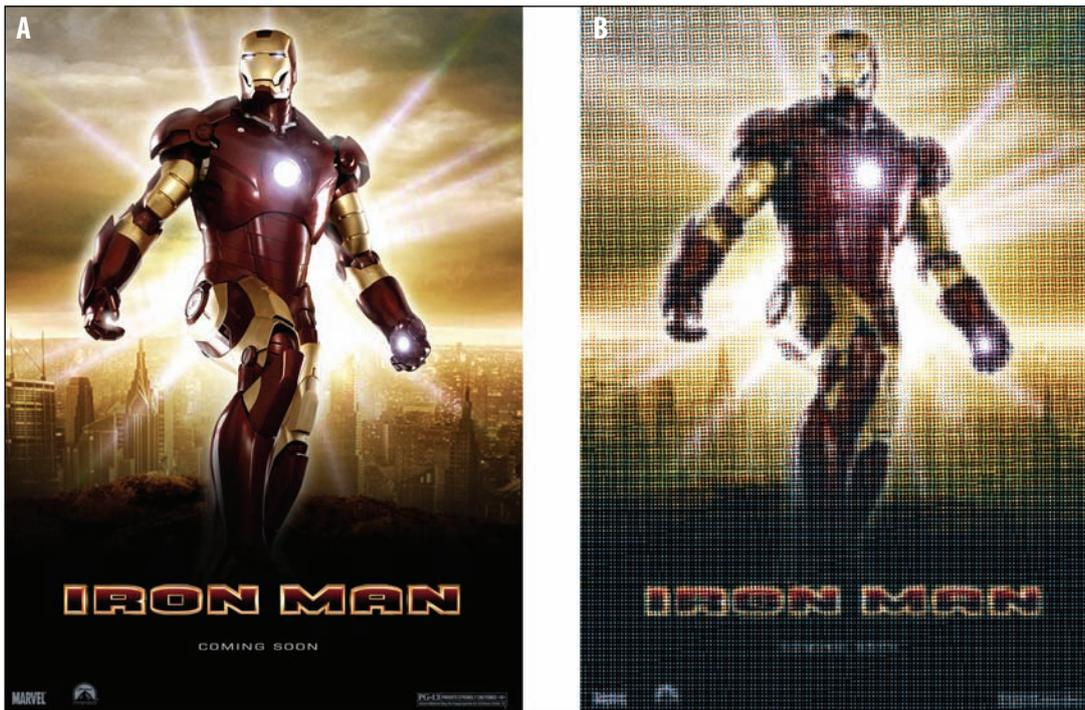
**Figura 4-2-5.** Con la correcta impresión de un medio tono se tendrá una imagen nítida (A), a diferencia del efecto reticulado cuando interfieren los puntos de las tramas entre sí (B).
