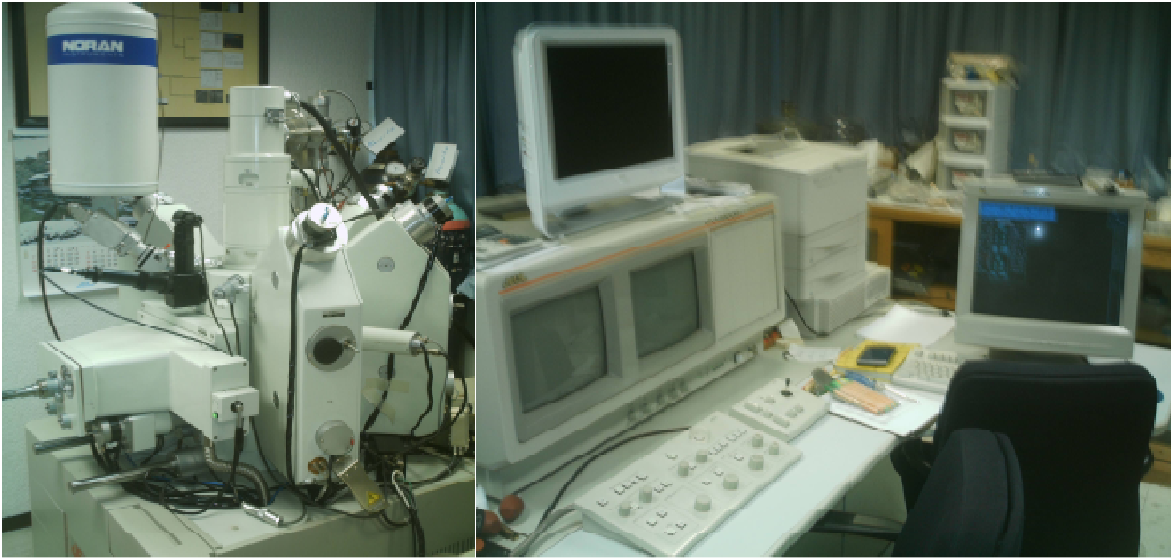
Fig. 15. Fotografía que muestra los componentes de la Microsonda Electrónica JEOL 8900Rc, equipada con cinco espectrómetros de longitud de onda.
