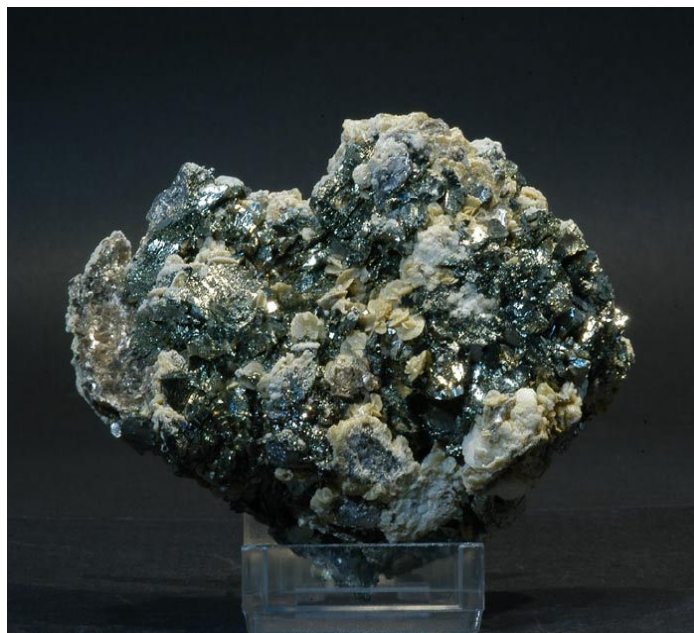
Fig. 6. Muestra de mineral de arsenopirita que contiene 46% de arsénico, 34,3% de hierro y 19,7% de azufre, junto con otros minerales.
