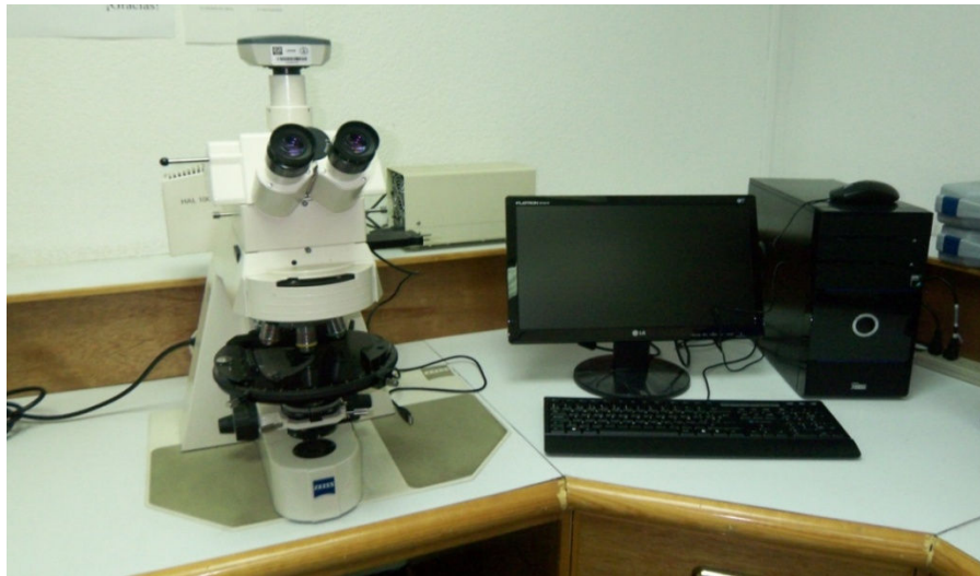
Fig. 12. Fotografía del microscopio petrográfico utilizado para realizar la caracterización mineragráfica y petrográfica. El microscopio es acoplado a una cámara digital y una computadora que incluye el software AxioVision, especializado para la obtención de las microfotografías del presente estudio.
