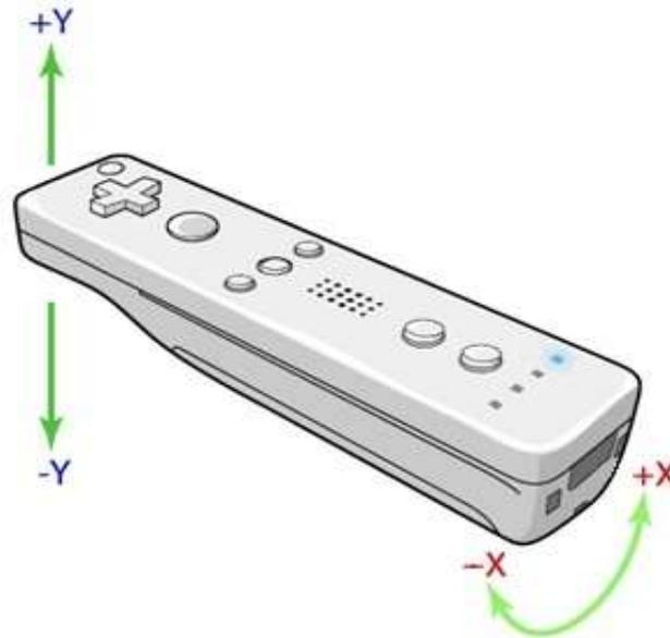
El movimiento horizontal se realiza girando el Wiimote sobre su propio eje, mientras que el vertical se realiza subiendo y bajando la parte superior respecto a la inferior.
