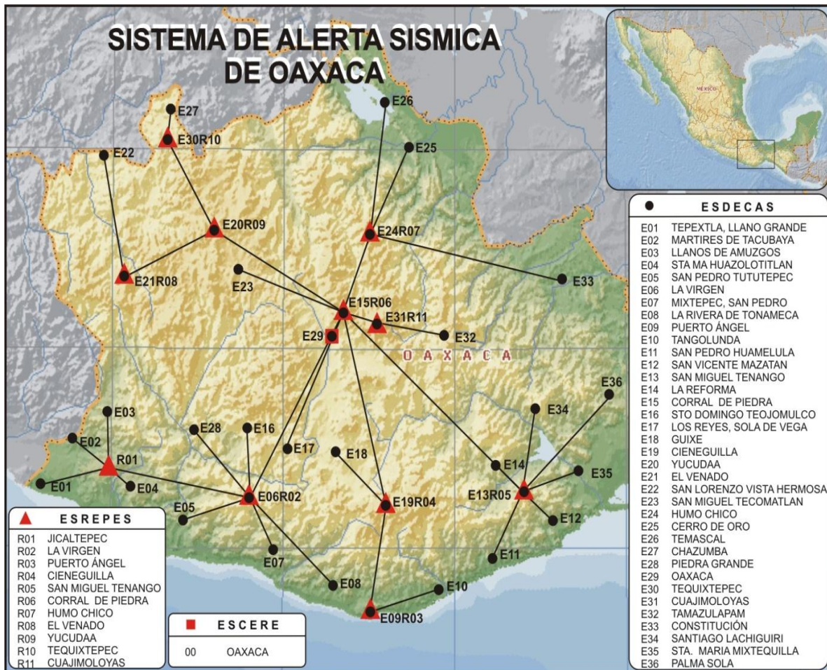
Figura 2.1. Mapa del estado de Oaxaca que muestra la localización de las estaciones de campo ESDECAS, estaciones repetidoras ESREPES, la estación central ESCERE del Sistema de Alerta Sísmica de Oaxaca.
