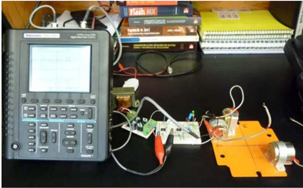
Fig 3.22 Acondicionamiento de señal del geófono GS11-D.
