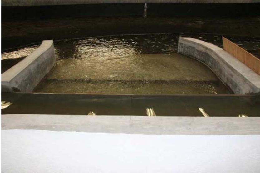
Vista del funcionamiento del vertedor del TEO para un gasto de  $80 \text{ m}^3/\text{s}$ .
