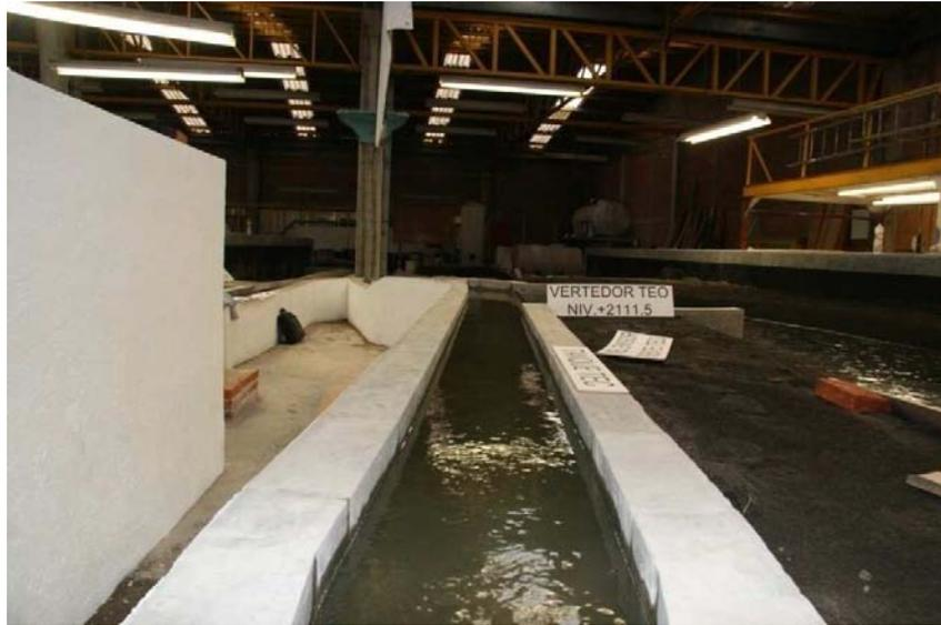
Comportamiento del canal de llegada con  $80 \text{ m}^3/\text{s}$
