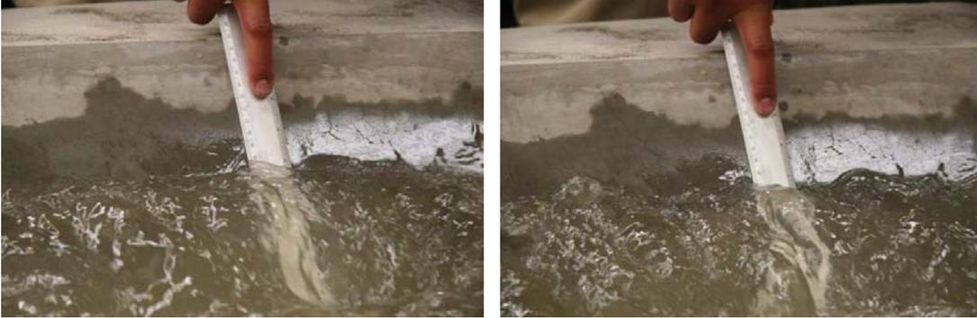
Las fotografías siguientes corresponden al tanque amortiguador del TEC en su punto medio, se anexa un resumen de los datos medidos; los tirantes son medidos sobre el talud.
