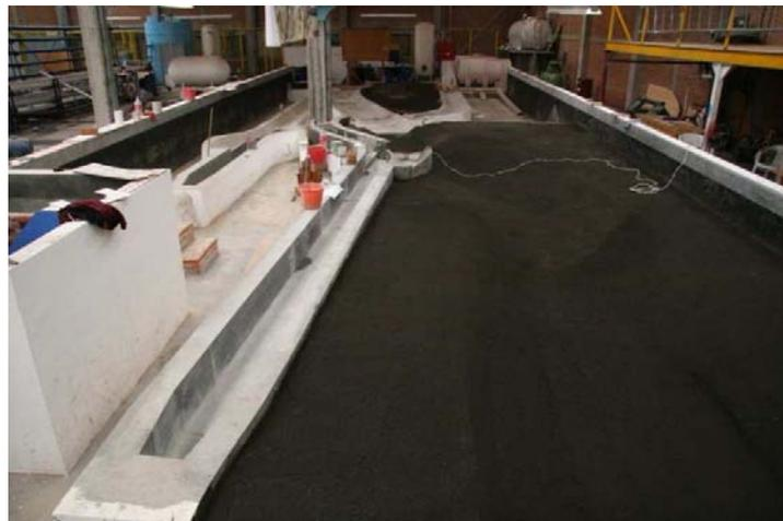
Fig. 5.5 Modelo de la obra de derivación del Túnel Emisor Oriente
