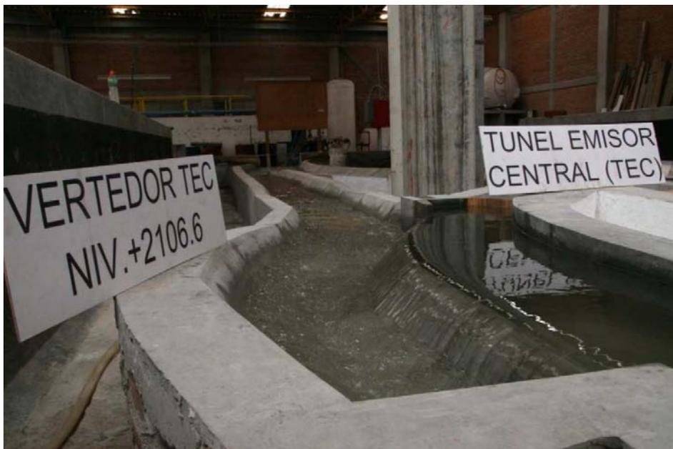
Compuertas cerradas, con gasto de  $100 \text{ m}^3/\text{s}$ , desalojados por el vertedor lateral.
