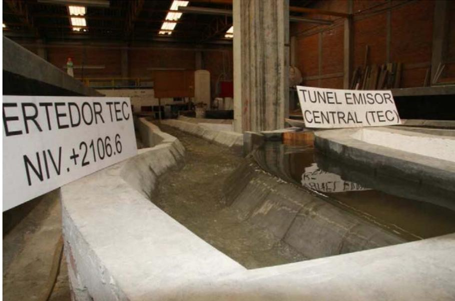
Compuertas cerradas, con gasto de  $50 \text{ m}^3/\text{s}$ , desalojados por el vertedor lateral.
