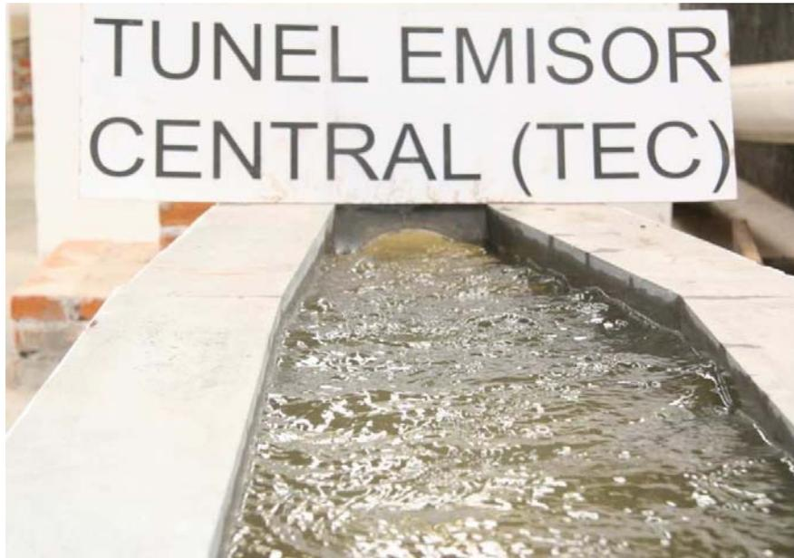
Portal de salida del TEC con gasto de  $150 \text{ m}^3/\text{s}$ . La descarga del túnel no se ahoga.
