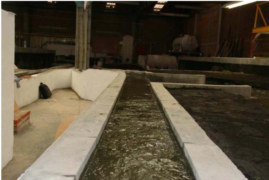
Comportamiento del canal con  $170 \text{ m}^3/\text{s}$
