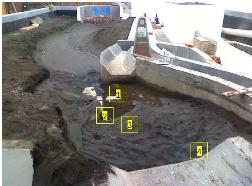
Fig. 9.3.2.2 Sitios de medición de socavación y configuración final después de una
