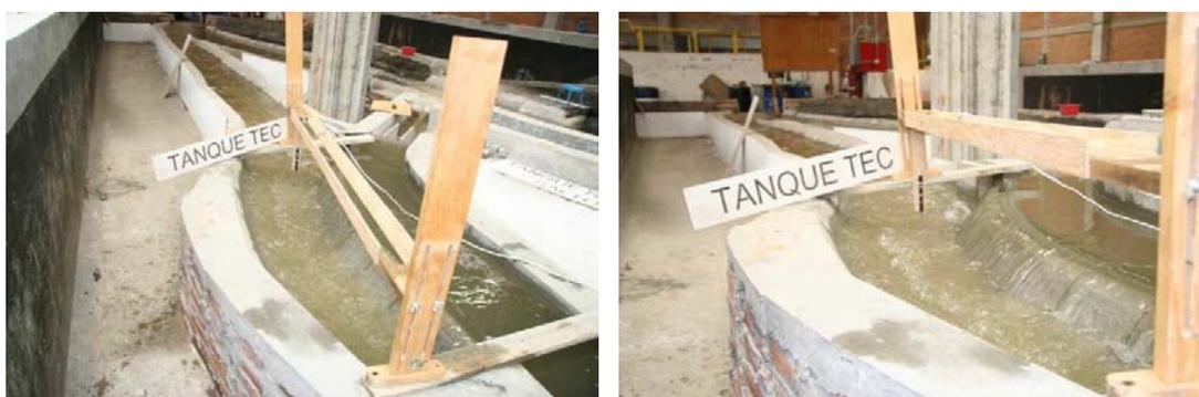
Las fotografías siguientes corresponden al tanque amortiguador del TEC en su inicio, se anexa un resumen de los datos medidos; los tirantes medidos sobre el talud.
