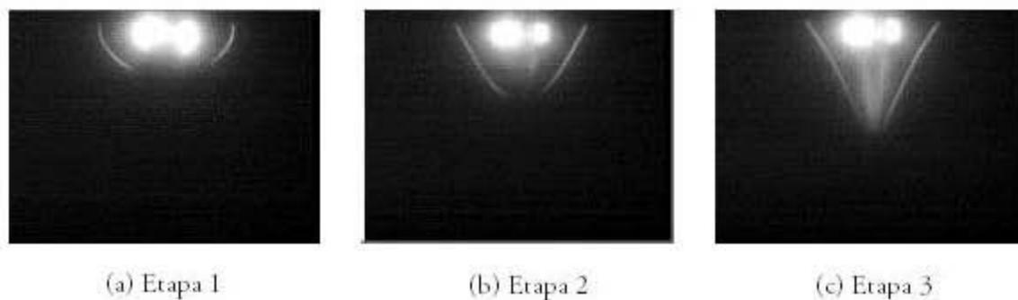
**Figura 2.8.** Formación de cono de Taylor. El voltaje incrementa en cada etapa hasta alcanzar el equilibrio entre la tensión superficial y la fuerza electrostática en la etapa 3 [69].
