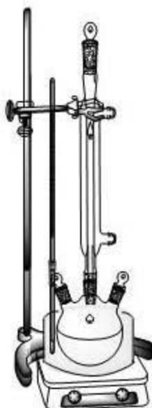
Figura 3.1. Montaje de reflujo para la reacción de injerto
