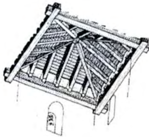
FIGURA 287. Enrique Nuere, Armadura de limas , 2003, 903 también llamada “de artesa”.
