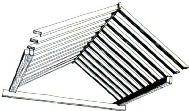
FIGURA 323. Enrique Nuere, Armadura de par-hilera , son las más sencillas que existen. Está integrada por los pares, la hilera y los soportes horizontales llamados estribos, 2003. 1005
