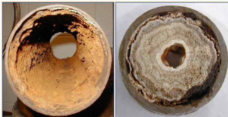
Figura 2-6 Ejemplo de incrustaciones dentro de tubos de acero al carbón
