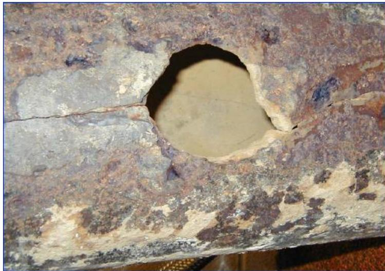
Figura 3-1 Ruptura debido a corrosión externa en tubería metálica
