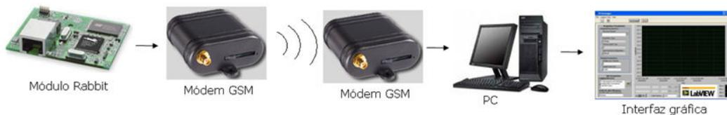
*Figura 20.* Diagrama general de un sistema de telemetría basado en GSM/GPRS.
