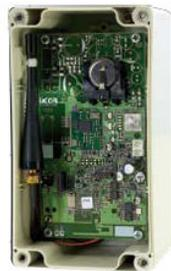
Figura 13. Router ZigBee (RC).
