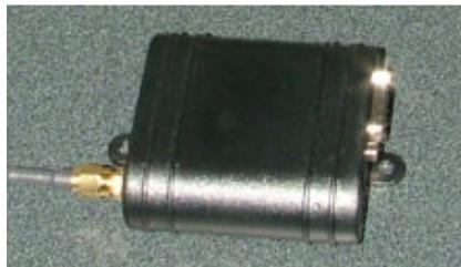
Figura 18. Modem GSM/GPRS Spider GSM1308.
