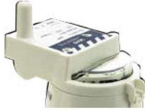
Figura 12. Radio ZigBee (ZED) adaptado en un micromedidor.
