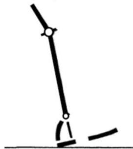
Figura 1.14 Falta de flexión reduce la capacidad de absorción de impacto en el apoyo
