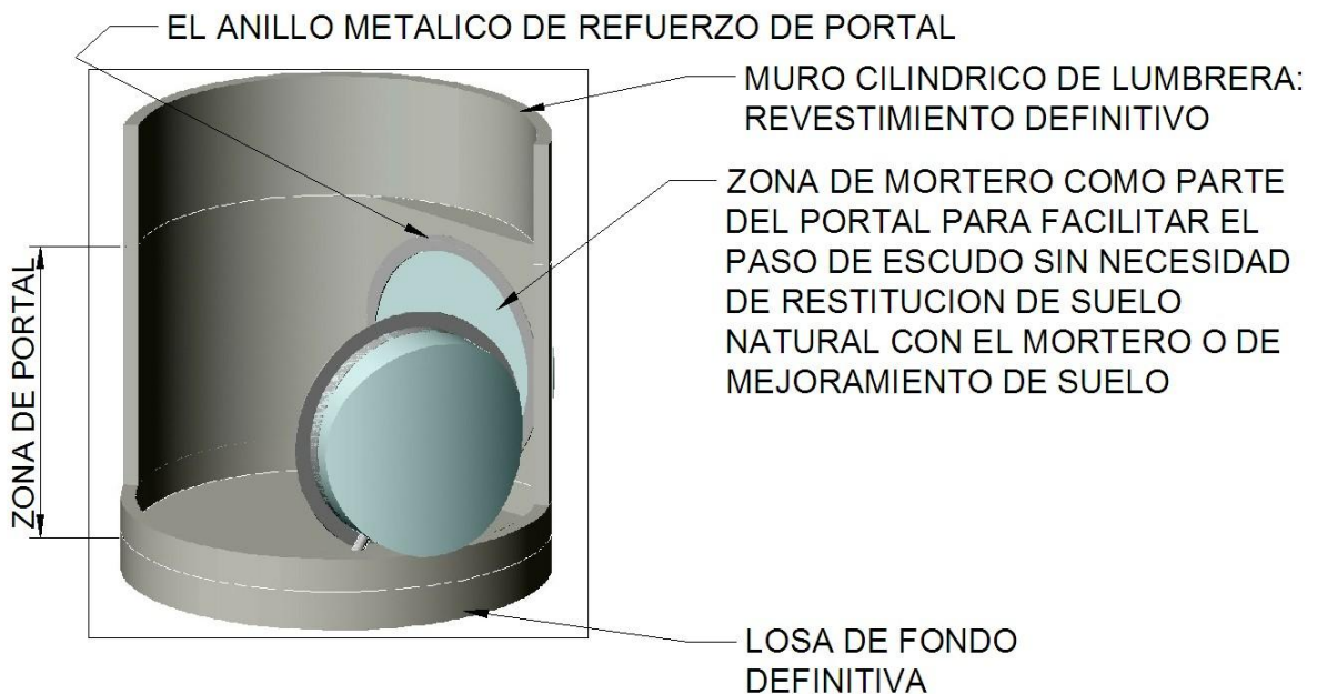
Figura 72. Zonas de mortero en los portales de lumbreira.
