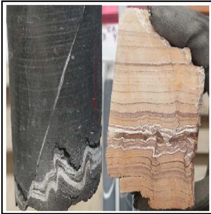
Figura II.15. Imagen que muestra estilolitas en un núcleo (HQ) en rocas sedimentarias (Galore, 2010).
