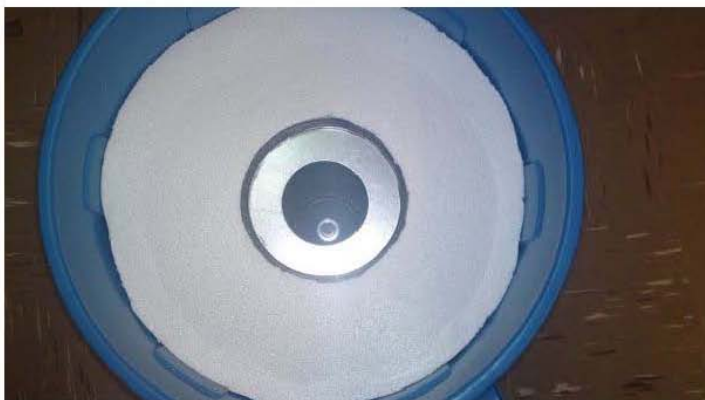
IMAGEN 5.2 USO DE UNICEL PARA DELIMITAR CAMARAS EN EL PROTOTIPO.
