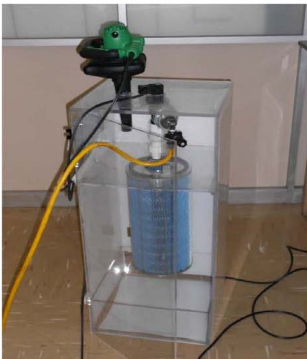
IMAGEN 5.8 COLECTOR DE POLVOS CON SISTEMA DE AUTOLIMPIEZA CONCLUIDO.
