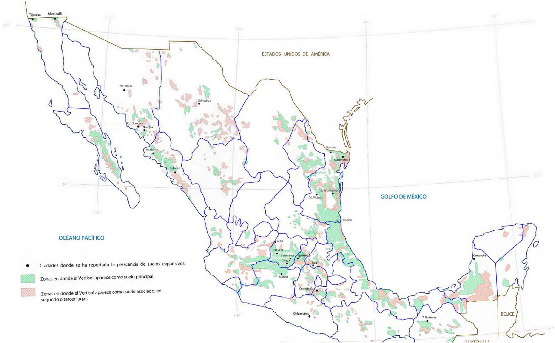
Ilustración I.8. Zonas potenciales de suelos expansivos en la República Mexicana (Zepeda y Castañeda, 1987)
