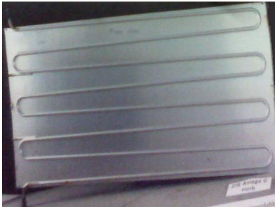
Figura 2.7 Absorbedor de aluminio, con tubo de acero inoxidable en serpentín.
