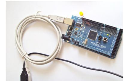
Se hicieron ensayos de cómo funcionan dos tipos de sensores con *Arduino*, se usó un sensor óptico reflectivo y un sensor de micrófono electret, que al ser activados ya sea por presencia o por sonido, controlan el encendido de un led, la forma de activar los pulsos comunica, por lo que las pruebas permitieron un análisis, para la selección del estímulo, por parte del visitante.
