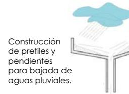
Construcción de preñiles y pendientes para bajada de aguas pluviales.
