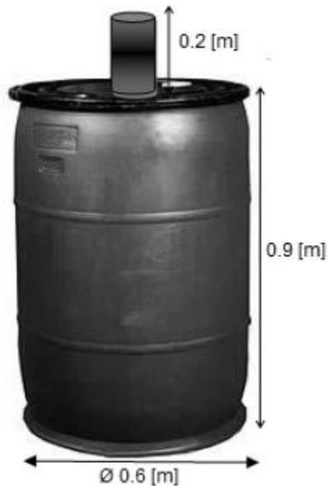
Figure 3.1: Dimensiones del biodigestor
