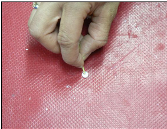
Foto 80. Perforación con abrasivo pedernal, carrizo y agua cuenta Tipo Disco.
