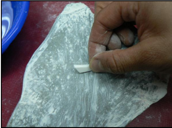
Foto 70. Desgaste de regularización de preforma de pendiente Circular A con arenisca.
