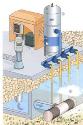
Figura 17: Toma de agua de la planta desalinizadora piloto
