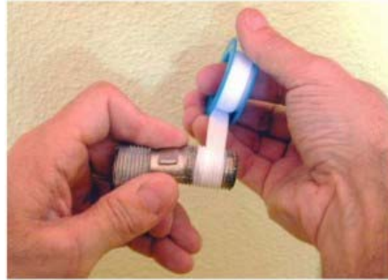
Figura 34: Aplicación de la cinta teflón
