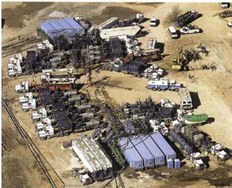
**fig. 1.1 - Fracturamiento hidráulico realizado en tierra, BJ Services.**
