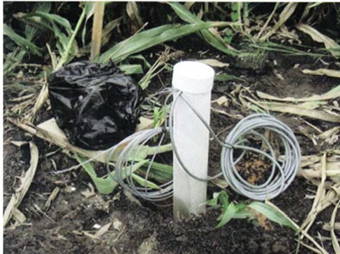
**fig. 2.19 – Inclínómetro de fondo, (Britt et al. 2006).**
