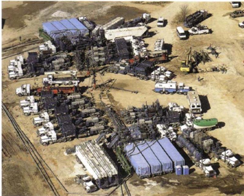
**fig. 1.7 - Proceso de fracturamiento hidráulico (BJ Services).**
