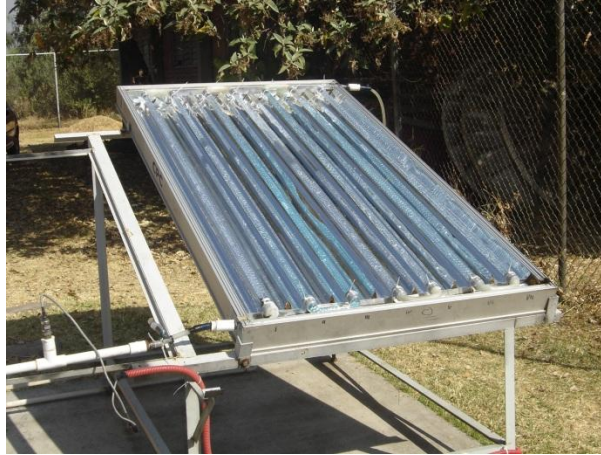
Fig.4.16. CPC con tubos de vidrio tipo boro-silicato de 25.4 [mm] de diámetro, esferas de 10 [mm] de diámetro y curvas de plástico.
