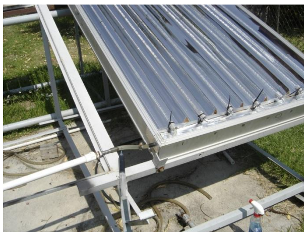
Fig.4.11. CPC con tubería de vidrio tipo boro-silicato.
