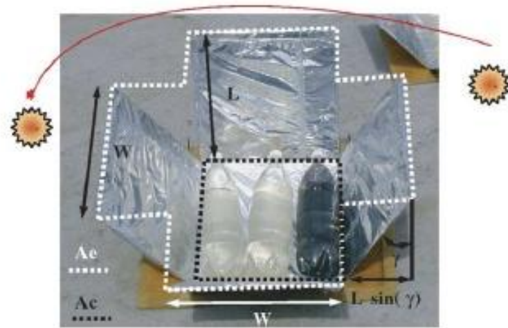
Fig.1.2. Concentrador cuadrado con 3 envases de plástico.
