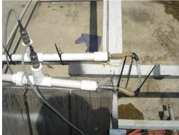
Fig.3.29. Curva en U de vidrio tipo boro-silicato.
